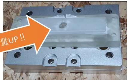
3Dプリンタで作成した樹脂型での射出量の確認
